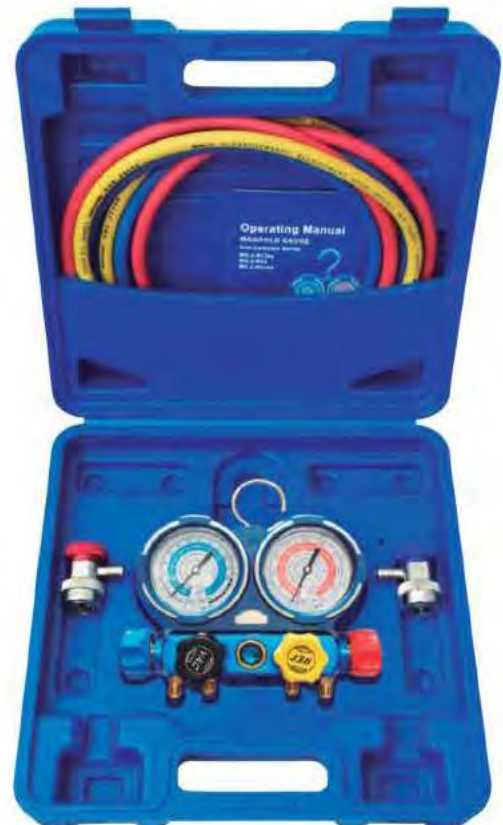
Contiene: 1 grupo manométrico 1234 YF 4 vías 1/4 SAE 1 enchufe rápido HP 1/4 SAE 1 enchufe rápido LH 1/4 SAE 3 tubos F 1/4 SAE 180° x F1/4 SAE (1800mm) Kit grupo manométrico 4 vías Ref. K-1017/100
