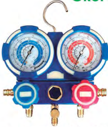
Grupo manométrico 2 vías 3 conexiones 1/4 SAE, manómetros Ø 80mm Refrigerantes: R22, R134a, R404a, R407c, R1234yf Ref. CA/C012
