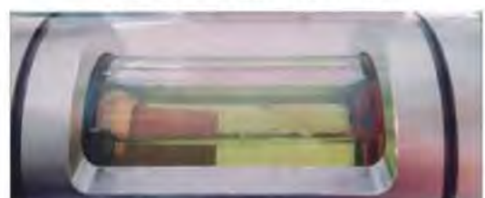
Preencia de humedad
