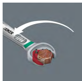
Efecto antideslizamiento La geometría de doble hexágono produce una unión perfecta y continua con el tornillo, y la placa metálica intercambiable y endurecida se aferra fuertemente al tornillo.
