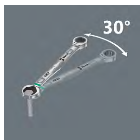
Ángulo de recuperación mínimo Ángulo de recuperación de 30° con diseño de hexágono doble. Con esto y con su cabeza recta ya no hace falta darle la vuelta a la llave.
