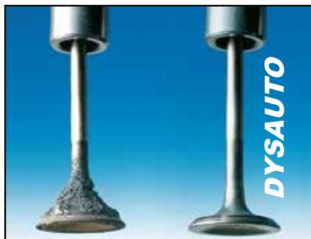
Eficiente limpieza del sistema de inyección, asegurando un preciso asiento de las válvulas.
