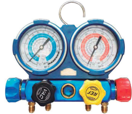
Grupo manométrico 4 vías 4 conexiones 1/4 SAE, manómetros Ø 80mm Refrigerantes: R22, R134a, R404a, R407c, R1234yf Ref. CA/C012/1
