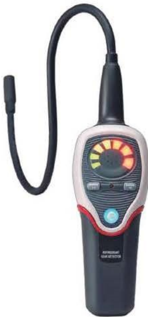
Detector de Fugas Electrónico Universal Ref. DFE/250
