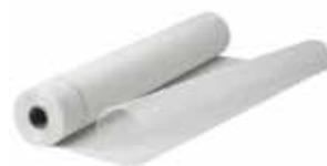
• Malla de fibra de vidrio con tratamiento superficial de elevada resistencia a los álcalis especialmente indicada en la aplicación de yesos en interior. También puede ser utilizada en aplicaciones de microcemento y como refuerzo en greses y mosaicos. Garantiza la estabilidad de los soportes favoreciendo una excelente resistencia a posibles fisuras.
