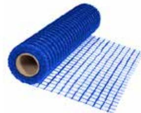
• Malla de fibra de vidrio con tratamiento superficial de elevada resistencia a los álcalis especialmente indicada como refuerzo y armado de soleras, capas de recocado tradicionales o microhormigones. Reduce hasta un 70% las fisuras de retracción frente al mallazo metálico. Con tratamiento de apresto especial para una mayor consistencia y firmeza.
